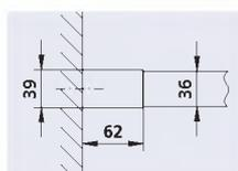
Possibilité d'ajustage de la largeur de la paroi fixe XS TW3 et XS TW4 dans le profilé mural + 10 mm / - 10 mm.
