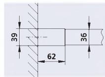
Possibilité d'ajustage de la largeur du Walk-in-Shower XS WALL XS WW3, XS WW4, XS WD3 et XS WD4 dans le profilé mural + 10 mm / - 10 mm.
