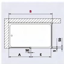
Largeur d'accès E Walk-in-Shower CORNER : E en mm = Largeur B - largeur A - 55 mm.
