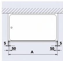
Dans le cas où le verre, le profilé viendrait se superposer sur un joint de carrelage du sol, il est important de s'assurer que ce joint est un joint durable (permanent dans le temps).
