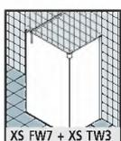
Walk-in-Shower XS FREE avec paroi fixe avec profilé XS FW7 XS TW3 avec paroi fixe à droite et support mural à gauche
