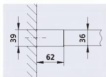
Possibilité d'ajustage de la largeur de la paroi fixe XS TW3 et XS TW4 dans le profilé mural + 10 mm / - 10 mm.
