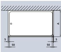
Dans le cas où le verre, le profilé viendrait se superposer sur un joint de carrelage du sol, il est important de s'assurer que ce joint est un joint durable (permanent dans le temps).
