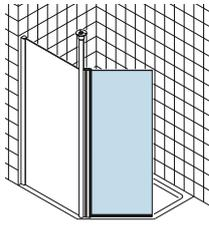
Biais réalisable dans le verre, schéma obligatoire, sur consultation (avec majoration). Il peut être fixé dans toutes les combinaisons d'angle entre 90° et 270°, voir schéma. L'élément mobile est repliable à 180°.
