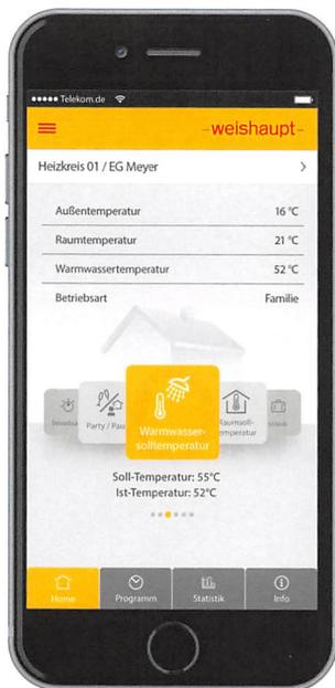
**App als Schnittstelle** Die neue Generation der Gas-Brennwertsysteme bringt die Heizung ins Internet. Ein wichtiger Schlüssel dazu ist die Weishaupt-App, die für iOS (Apple) und Android (Google) erhältlich ist und die auf Smartphones sowie Tablet-Computern installiert werden kann.
