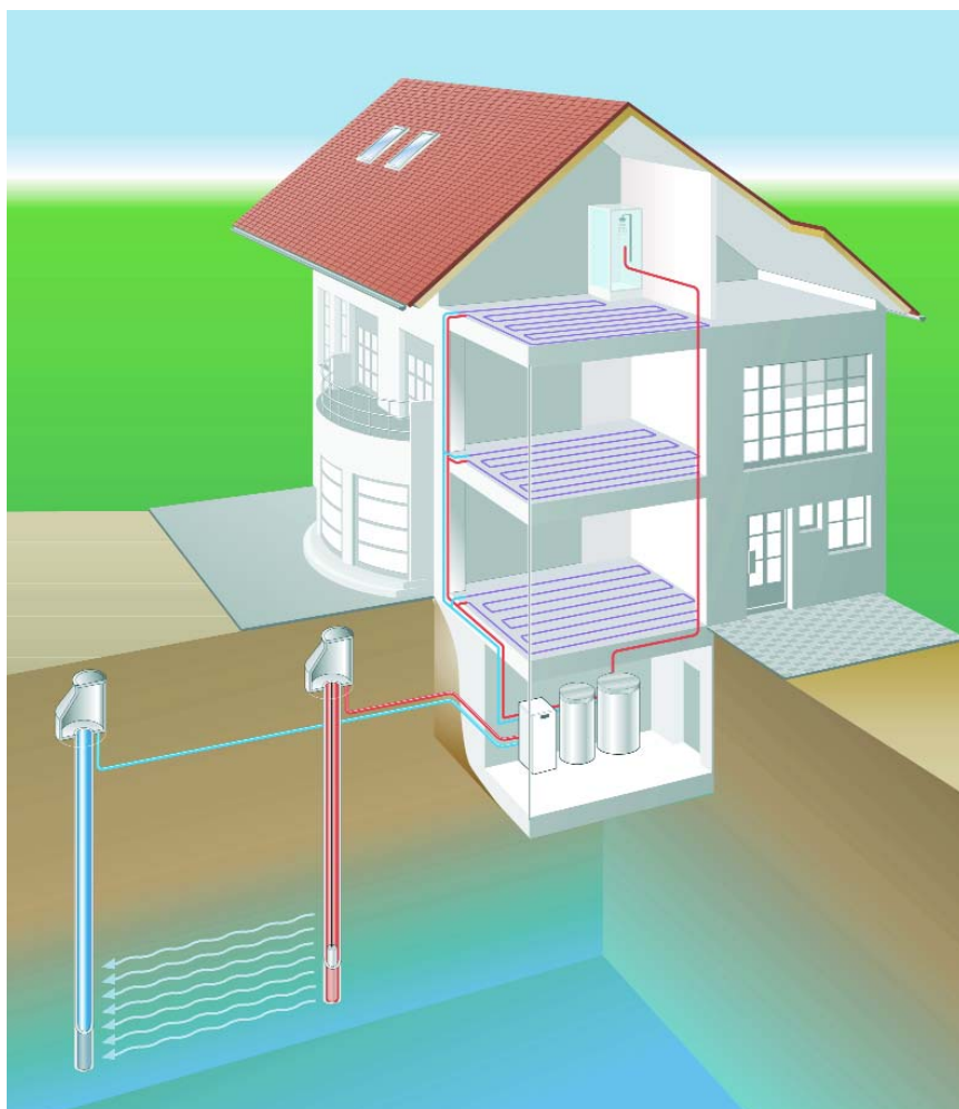
Pompe à chaleur eau/eau
