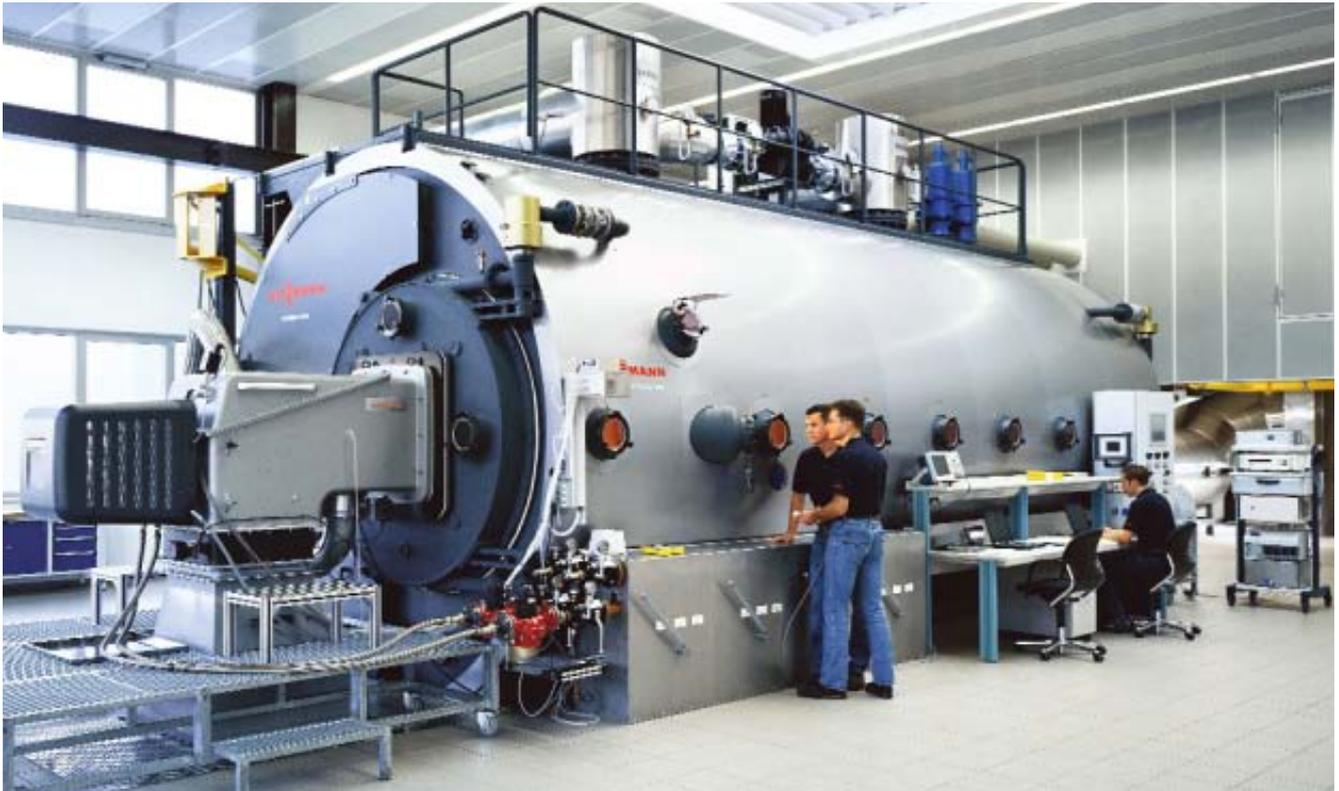
Les brûleurs jusqu'à 32 MW sont testés sur le plus grand tube d'essai au monde au centre de recherche de Schwendi
