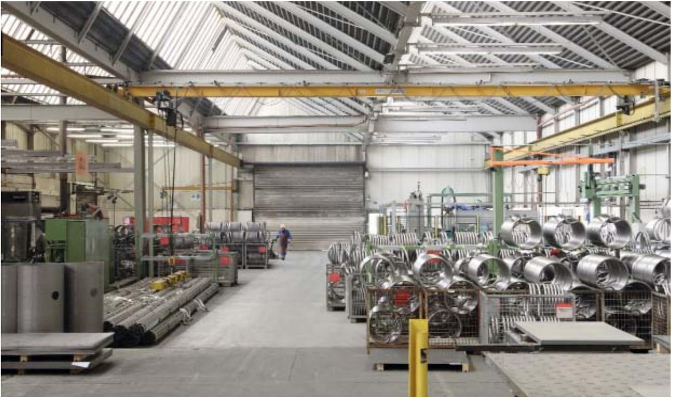
Hall de fabrication et de stockage des échangeurs tubulaires
