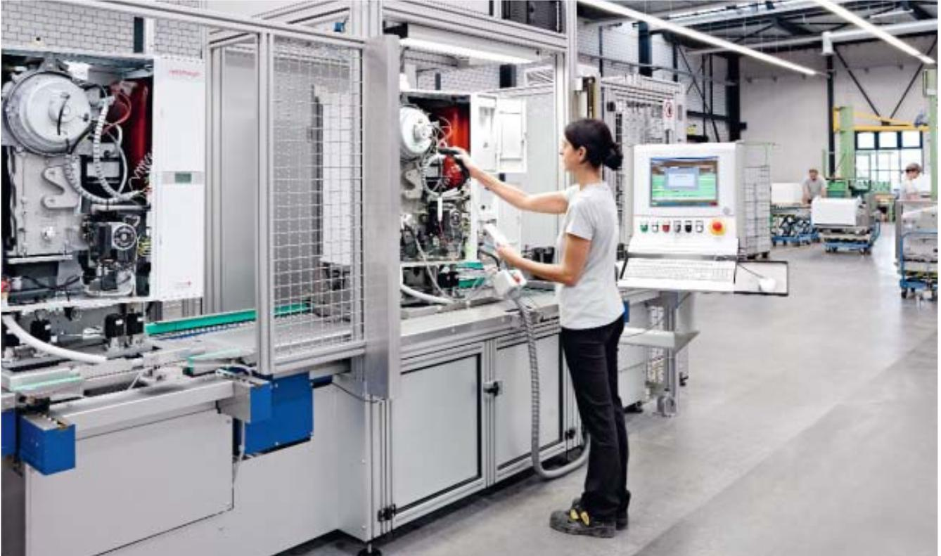
Banc d'essais des chaudières à condensation gaz
